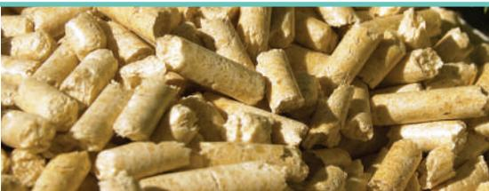
Le granulé s'est développé très récemment et a eu une croissance fulgurante en Rhône-Alpes. Il est produit dans des usines de granulation, par la compression de la sciure en provenance des scieries. Le granulé est normé, très dense et homogène, il concentre beaucoup d'énergie. Il est utilisé principalement chez les particuliers (poêle, insert...) ou dans le tertiaire et les collectivités. Il se livre en sac ou en vrac.
