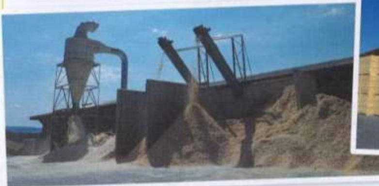
Les produits connexes (plaquettes et sciure) sont acheminés, soit par aspiration, soit par élévateur à raclette à l'arrière de la scierie. Ils seront chargés au godet dans des bennes appropriées. Direction les chaufferies pour les plaquettes et la fabrication de pellets pour la sciure.
