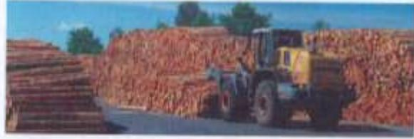
Un pelle mécanique, Liebherr 904, vide les casiers et gerbe les billons sur des piles où vient s'approvisionner l'autre chargeur, Liebherr 550, pour alimenter la chaîne d'aménagement de la scierie par campagnes d'essence et de diamètre billon.
