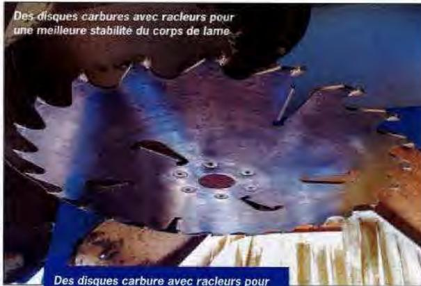
Des disques carbures avec racleurs pour une meilleure stabilité du corps de lame
