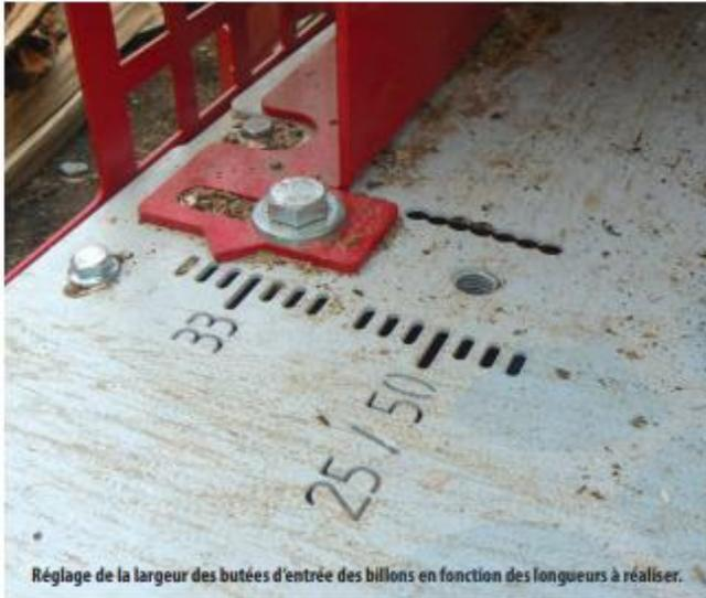
Réglage de la largeur des butées d'entrée des billons en fonction des longueurs à réaliser.
