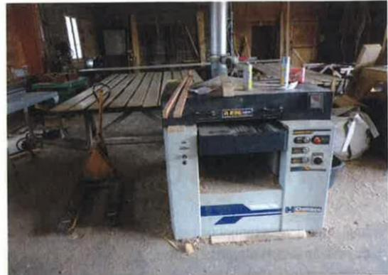
L'entreprise dispose d'un parc de machines traditionnelles, incluant notamment scie circulaire, scie radiale, scie à format, mortaiseuse, et une raboteuse bénéficiant d'un positionnement numérique.
