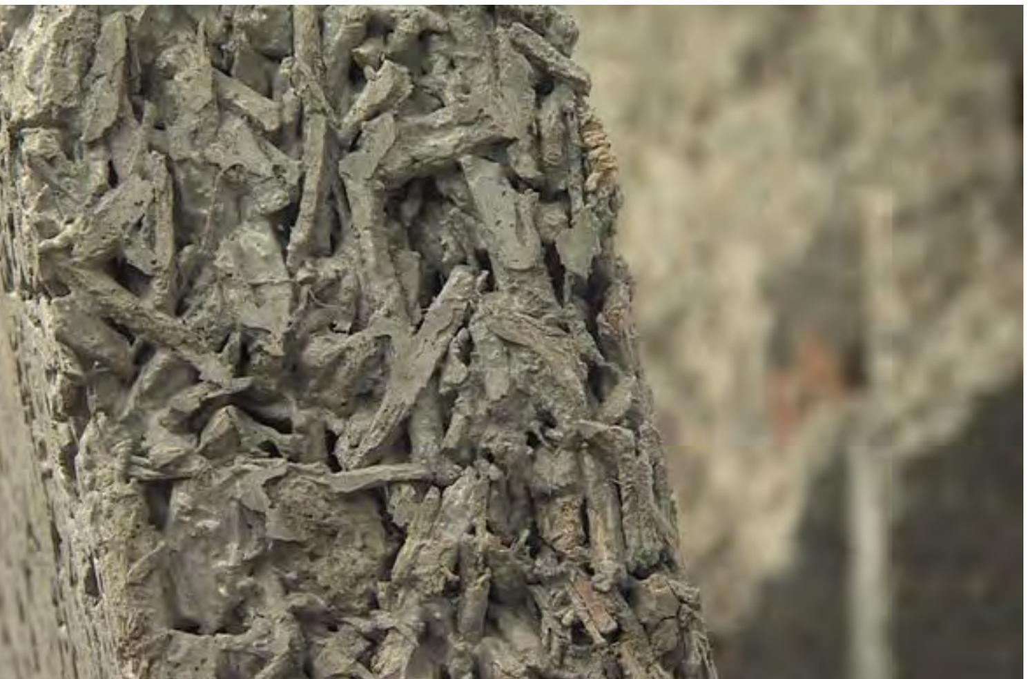
Le béton de bois TimberROC est réalisé avec un mélange innovant composé d'eau et de plaquettes de bois.
