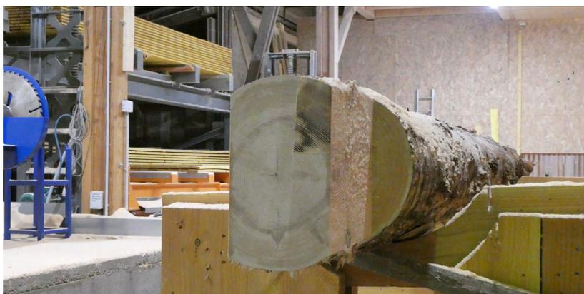
**STENT-BOIS** permet de valoriser les grumes de Sapin d'Auvergne-Rhône-Alpes dont le diamètre dépasse 80 cm avec très peu de transformation.
