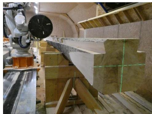
Figure 6 : Usinage robotisé d'une grume
