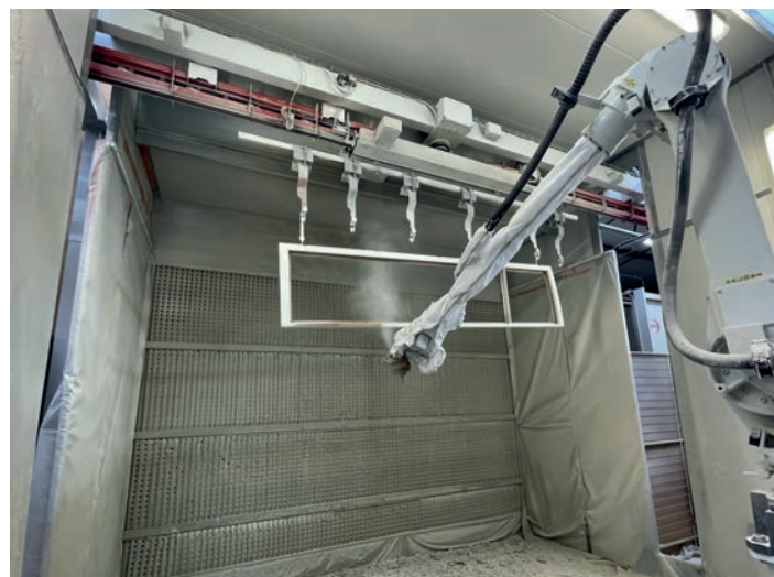
Robot de peinture chez SEDEC ©SEDEC à St-Pourçain-sur-Sioule (03)
